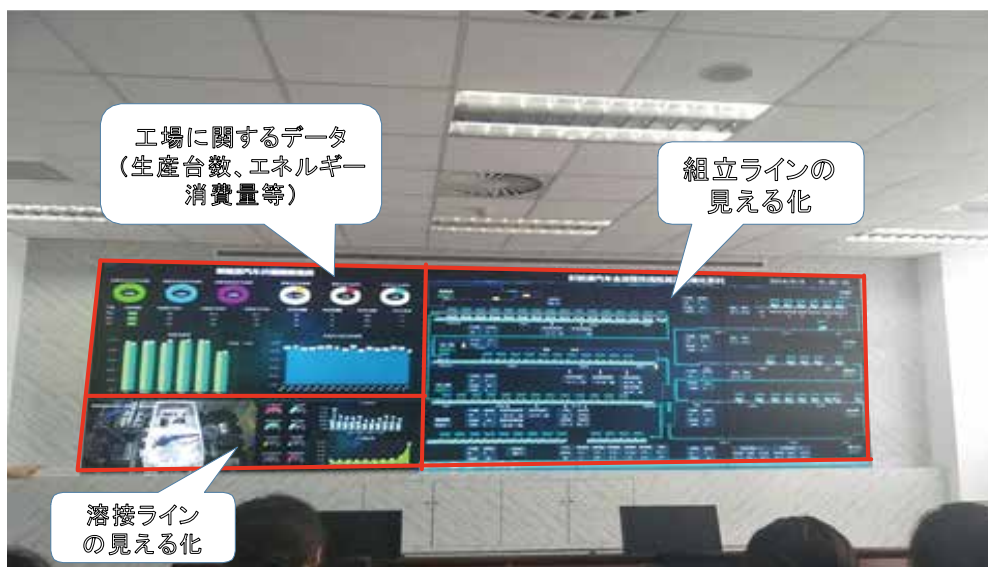
図3-3 BEV「小蚂蚁」の工場のリアルタイム監視システム 出典：筆者が撮影した写真(2019年9月5日)
