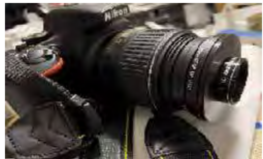
図26 回折格子をカメラレンズへ装着
